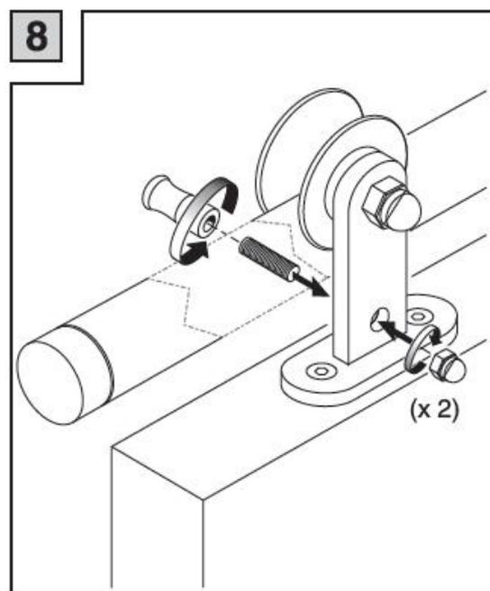
**Remarque = Pour augmenter l'espace entre la porte et le mur, utiliser les entretoises 5 mm fournies !! Attention, le guide bas (figure 6) est à positionner à 42+5 mm**
