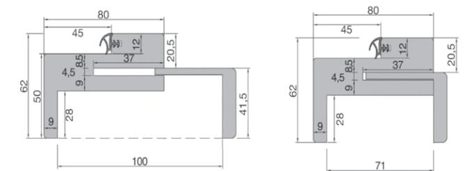
Élargisseur KM1 cloison > 110 mm, bandes bouvetées de 40 mm.
