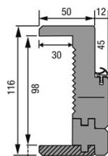
Elargisseur KM1 jusqu'à cloison de 400 mm
