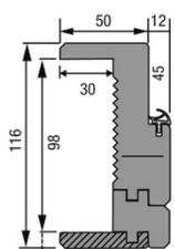
Elargisseur KM1 jusqu'à cloison de 400 mm
