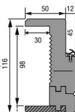
Elargisseur KM1 jusqu'à cloison de 400 mm
