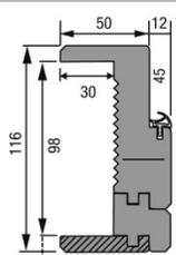
Elargisseur KM1 jusqu'à cloison de 400 mm
